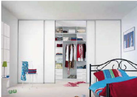
Raumverkürzung So manches lange Zimmer lässt sich kürzen, indem man statt eines Schränks an der Stirnwand eine vorgezogene Schliebe-Anlage installiert. Dahinter können nun Aufbewahrungseinrichtungen eingebaut werden. Wie weit die Fronten vorgesetzt sind, hängt von der Raumgröße ab oder vom Platzbedarf im begehbaren Bereich.
